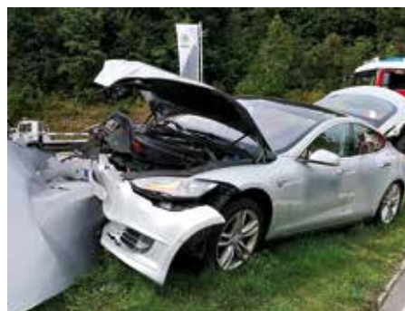
Da bei dem Unfall am 29. August in der Ramsauer Straße ein E-Fahrzeug beteiligt war, und nicht einwandfrei geklärt werden konnte, ob die Batterie beschädigt ist, verladen wir das Fahrzeug in einen wasserdichten Container, damit in einem Brandfall die Batterie leichter gekühlt werden kann.
