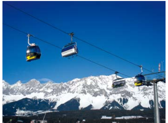
Sessel-Sessel-Sessel-Gondel. Optimal für Genuss-Skiläufer und Sportler – die neue Telemix-Seilbahnanlage auf die Hochwurzen.
